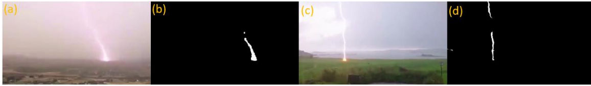
Figura 2-28: Resultado de segmentación en cuadros con fondo de alta intensidad realizado a los videos 112 y 113
